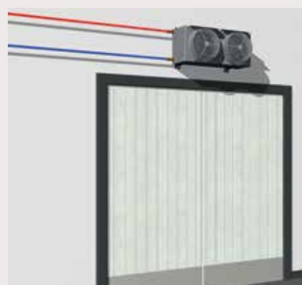
Överskottsvärmen kan användas till att värma upp andra lokaler t.ex. närliggande lagerlokaler.
