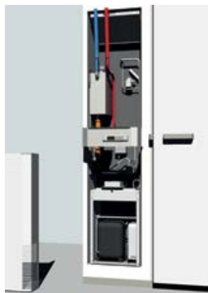
Vattenledningar kopplas från en externt placerad kondensator till kylaggregatet.
