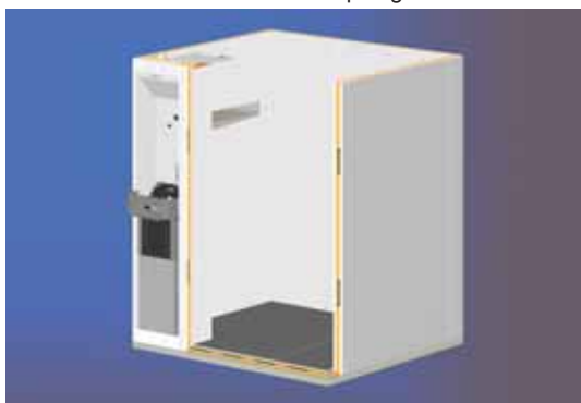
Fig 7. Montering av veggelementene
