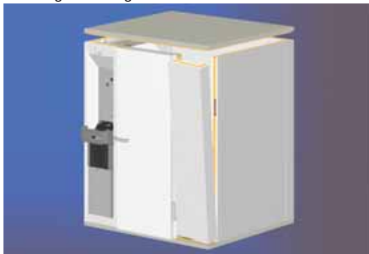
Tek. 8: Montage van het hoekelement en de plafondelementen
