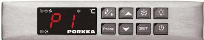
**"P1"** Termostatgivare defekt\*\*\*
