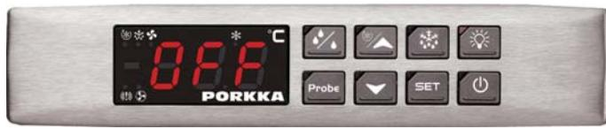
Om knappen trycks ned visar maskinen "OFF" i 5 sekunder och ON/OFF-knappljus tänds. I läget OFF stängs alla reléer AV och reglagen stoppas. Om ett övervakningssystem finns inkopplat registrerar det inte information och alarm för maskinen. OBS! I läget OFF är knappen Ljus aktiv. Att koppla maskinen på tryck knappen igen.
