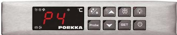
**"P4"** Tilläggsgivare defekt\*\*\*
