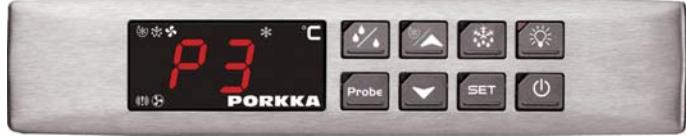
**"P3"** **Alarm defekt kondensatorføler\*\*\***
