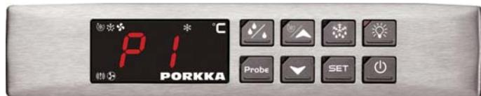
**"P1"** Sisälämpötila-anturin virhe\*\*\*
