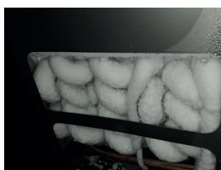
Dette kan forårsakes av at døren har stått på gløtt eller at luftfuktigheten er høy. Kontroller at det ikke er is på luftsirkulasjonslukene på bakkanten av maskinkassetten. Om du ser is eller mistenker at fordamperen er overiset start en manuell avriming i henhold til bruksanvisningen. Gjenta manuelle avriminger inntil at fordamperen er helt isfri. Om maskinen etter dette ikke oppnår innstilt temperatur, kontakt et autorisert servicefirma.
