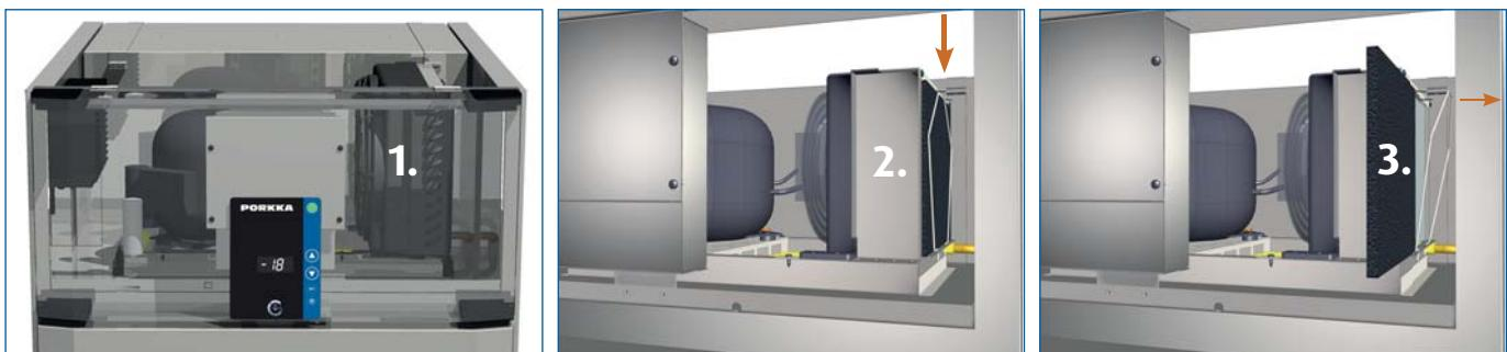
Luftcirkulationskanaler i skåpet kan tas bort utan verktyg, så att det är lätt att rengöra alla ytor. Rygg- och takkanaler är förankrade med fingerskruvar med myntspår för att underlätta öppnandet.
